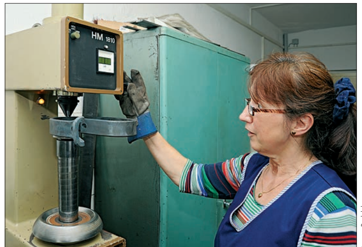
Im Qualitätslabor testet Mitarbeiterin Monika Leuschner von jedem Fertigungsschritt jedes 50. Teil auf die geforderten Materialeigenschaften, hier bei der Härteprüfung nach dem Rockwell-Verfahren. Dabei wird gemessen, wie tief ein Diamantkegel mit definierter Kraft in den Stahl eindringt.
